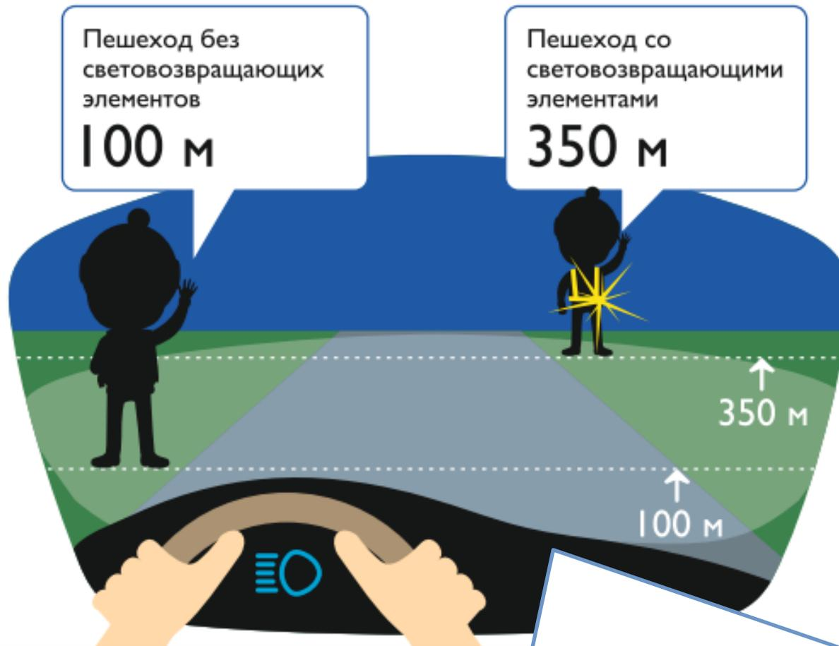
При движении автомобиля с дальним светом фар дистанция, на которой пешеход становится виден, с применением световозвращателей увеличивается со 100 метров до 350 метров.
